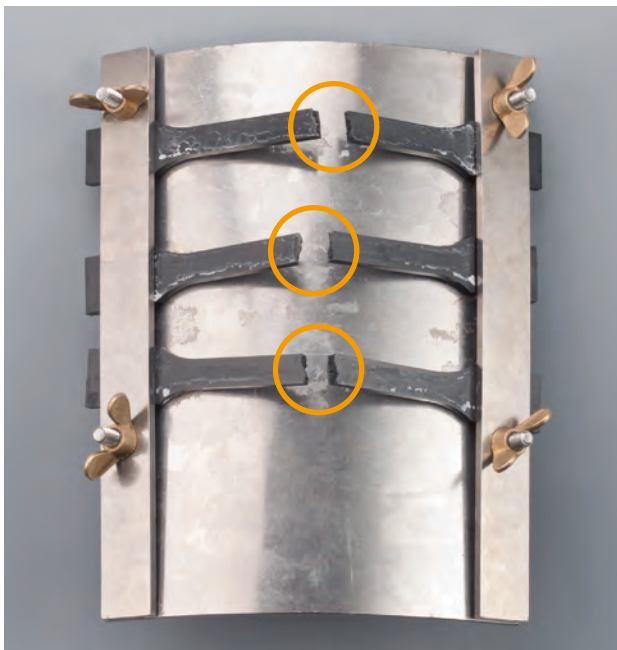
Abb. 5: Test der Spannungsrissbeständigkeit im Biegestreifenverfahren, analog DIN EN ISO 22088-3; links Ultradur ® B4300 G6 sw 5110, rechts Ultradur ® B4330 G6 HR sw 15045
