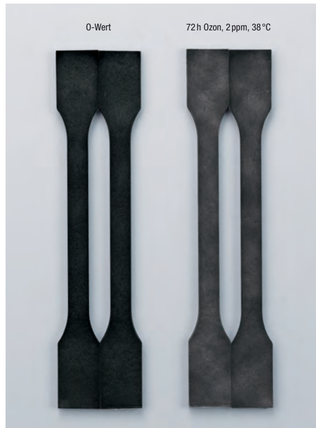
Abb. 56: Prüfstäbe aus Ultramid ® TKR 4355 G7 sw 564 vor und nach Ozoneinwirkung. Die Farbe der Prüfstäbe hat sich durch die Ozoneinwirkung etwas aufgehellt, die Werkstoffeigenschaften bleiben aber weitgehend erhalten.
