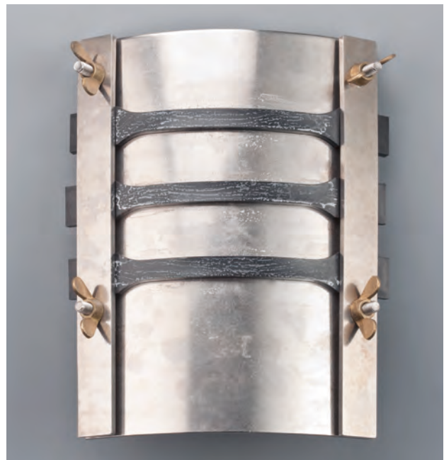
Abb. 5: Test der Spannungsrissbeständigkeit im Biegestreifenverfahren, analog DIN EN ISO 22088-3; links Ultradur ® B4300 G6 sw 5110, rechts Ultradur ® B4330 G6 HR sw 15045
