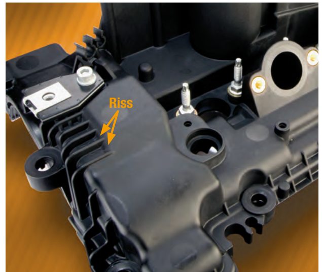
Abb. 4: Sichtbare Oberflächenschäden nach Kurzzeit-Kontakt mit Schwefelsäure (2%)
